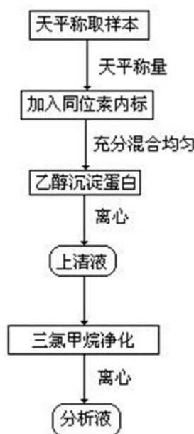
图1 样品的处理流程图
