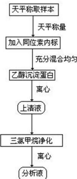
图1 样品的处理流程图
